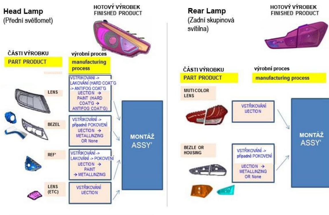
Výrobní proces od vzniku výlisků z termosetů nebo termoplastů má charakteristické postupy, které se dělí do dvou skupin:
