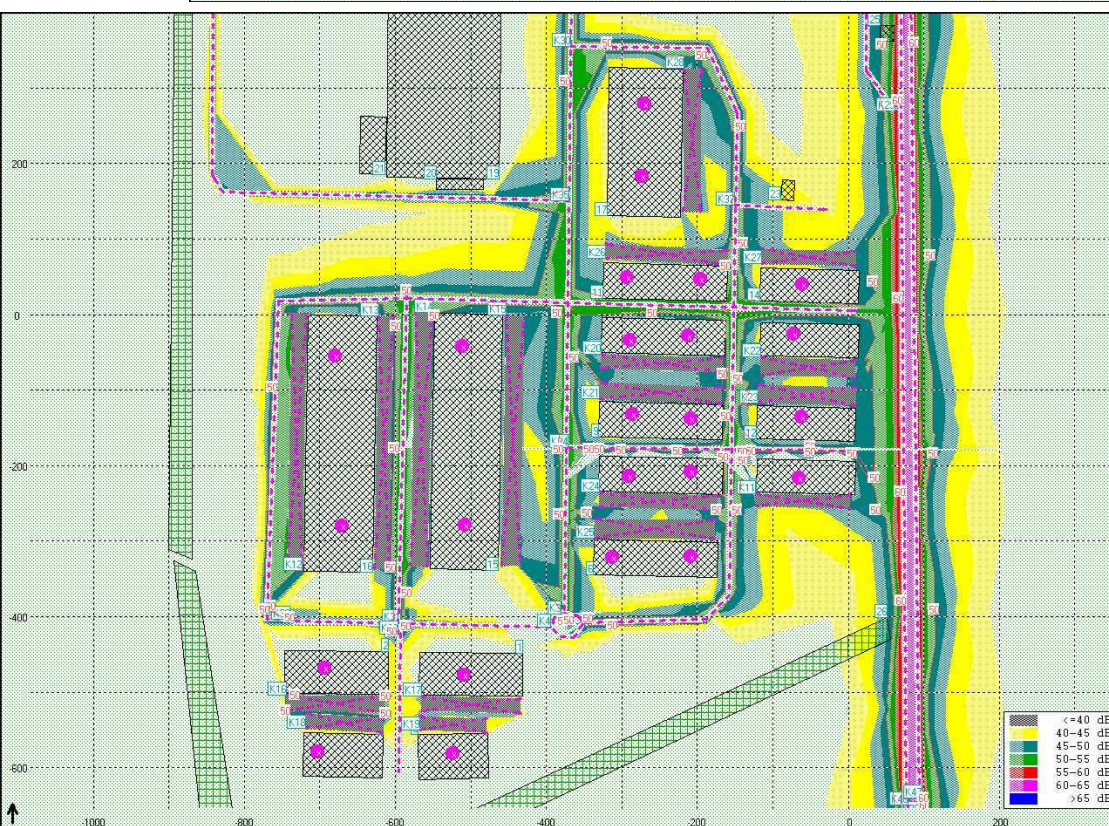
GRAFICKÉ ZNÁZORNĚNÍ IZOFON – POUZE PROVOZU CTP OSTRAVA HRABOVÁ – II.FÁZE VÝSTAVBY VČETNĚ VEŘEJNÉ DOPRAVY – NOC
