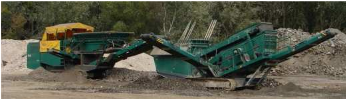
Obr. 3 – Mobilní linka sestavená z drtící jednotky RESTA 1050x1000 a třídící jednotky RESTA 1200x3000/2
