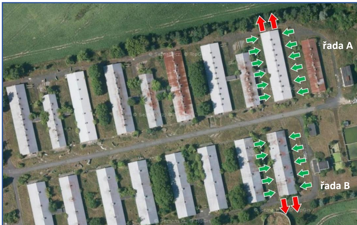
Obrázek 7 – Naznačení směrů proudění vzduchu – ventilace objektů – ilustračně pro 1 halu z každé z řad A i B
