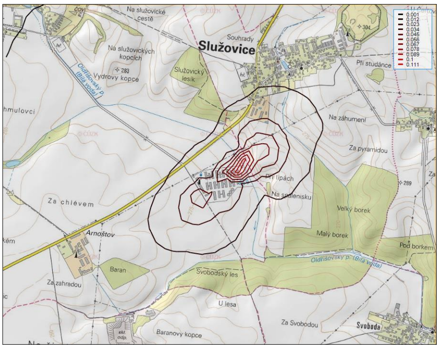
Obrázek č. 11 Grafické znázornění průměrných ročních příspěvků k imisní koncentraci NO 2 [µg/m 3 ]
