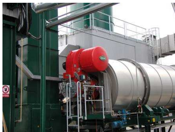
sušící buben s hořákem
