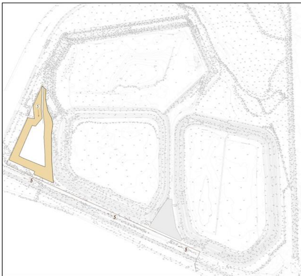
Obrázek č. 7: Dočasná deponie skrývkového materiálu z prostoru výstavby závodu
