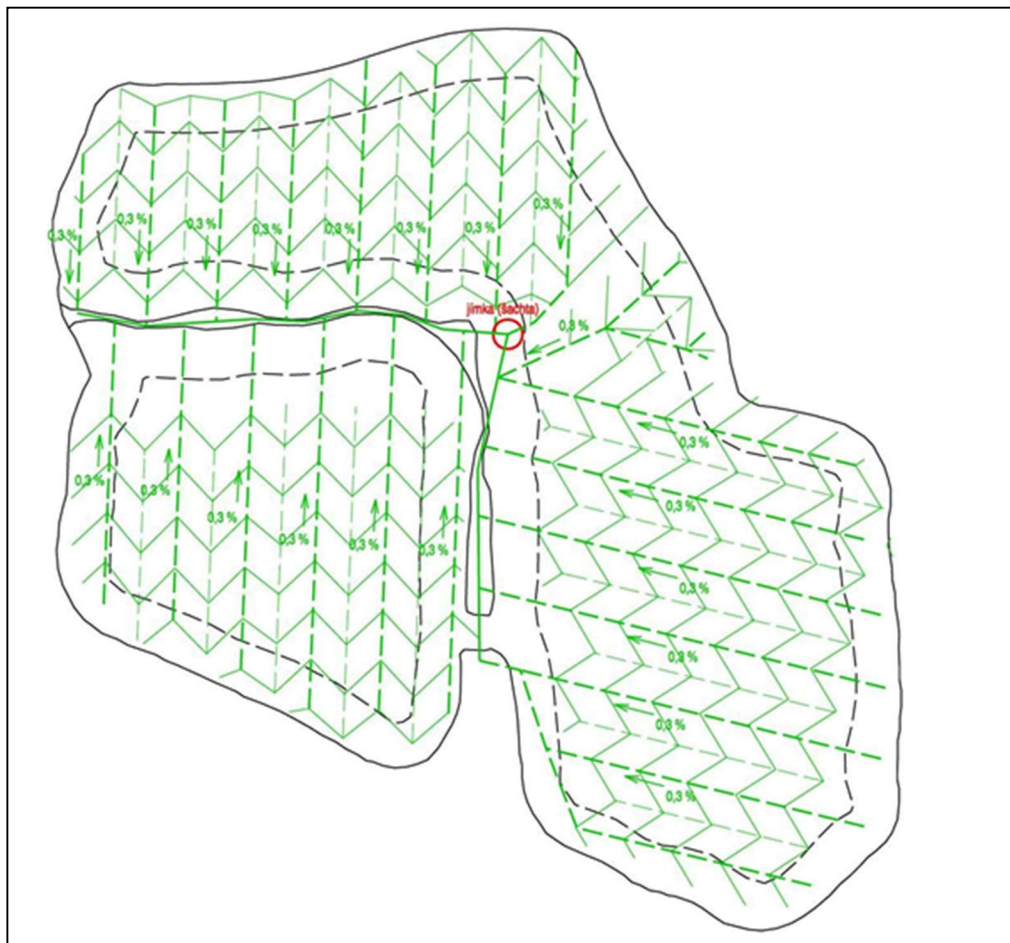
Obrázek č. 47: Hlavní odvodňovací drenážní systém pod úložištěm těžebního odpadu
