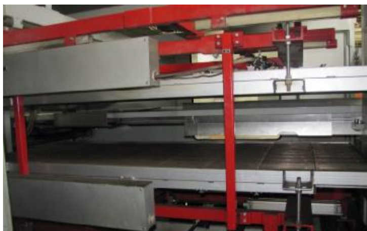
Horní a spodní elektrické topné pole pro ohřev materiálu
