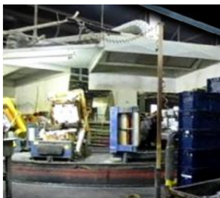
Otočná pěnící linka – karusel
