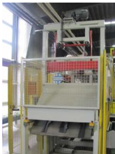
Prostor stříhu materiálu s „gilotinou“
