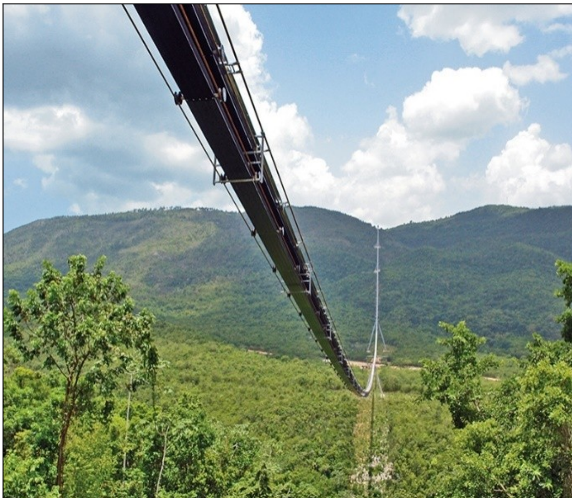
Obr. 7 Pásový dopravník RopeCon nad korunami stromů – varianta 1 (ilustrační foto)
