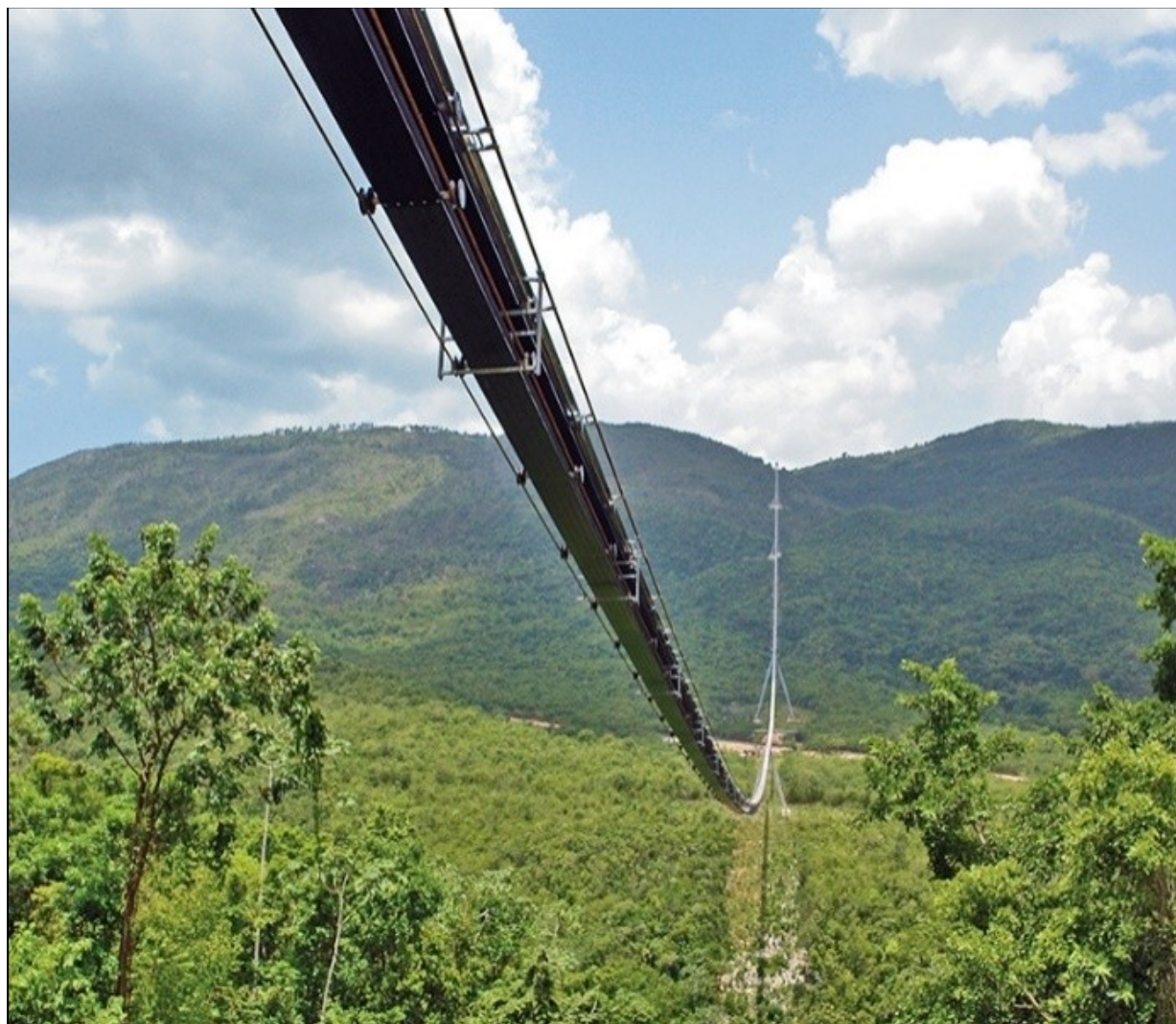
Obr. 11: Pásový dopravník RopeCon nad korunami stromů (ilustrační foto)
