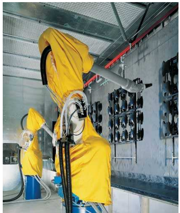
Obr. 3 – Lakovací kabina linky AFOTEK se 2 stříkacími roboty ( http://www.afotek.de/Cz/index_cz.html )
