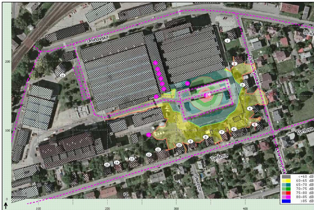
Obr .č. 6 Hladiny hluku ze stacionárních zdrojů, období výstavby, denní doba
