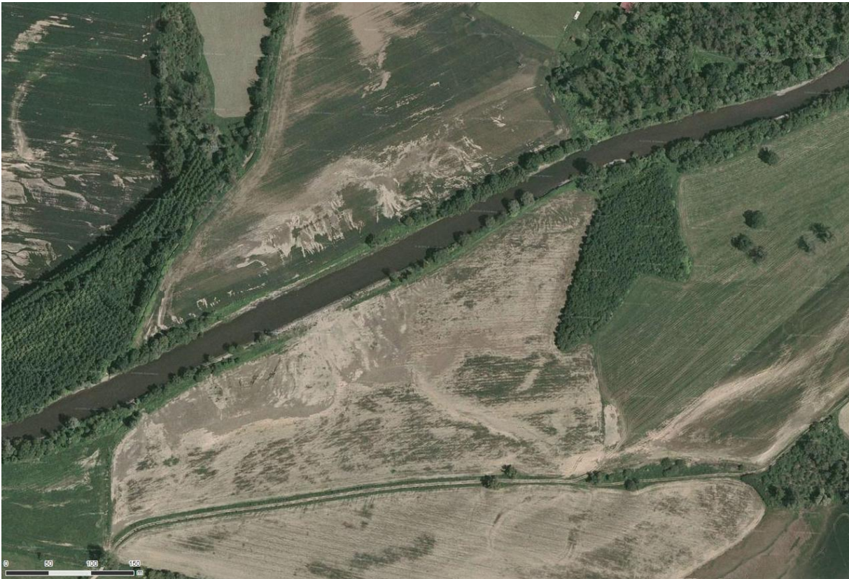
Obr. C.1.4: Rozsah půdní eroze na pozemcích v dolní části úseku
