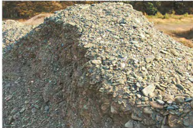
Foto – 11 Pohled na výkopek říčního štěrku v horní části deponie.
