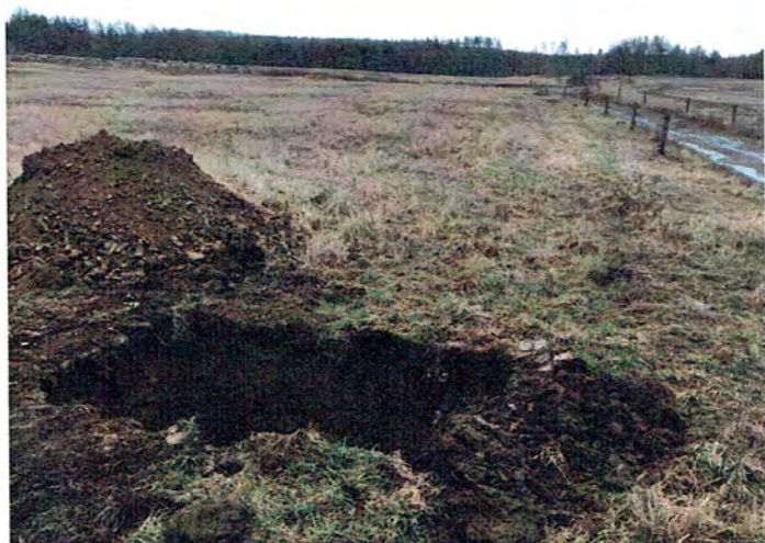
Obr. č. 3: Výkop J-1 po ukončení vsakovací zkoušky
