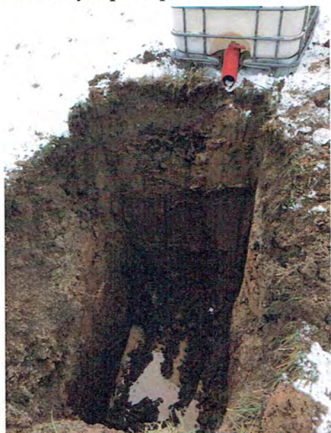
Obr. č. 3: Výkop J-1 po ukončení vsakovací zkoušky
