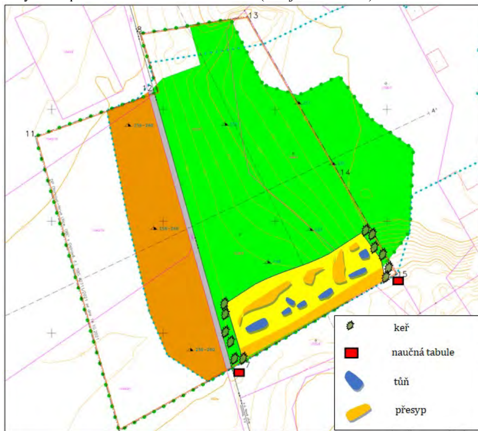
Obr. 4: Schéma možné podoby rekultivace plochy pro potřeby ochrany přírody v dobývacím prostoru Olomouc – Nová Ulice (zdroj: Merta 2022).
