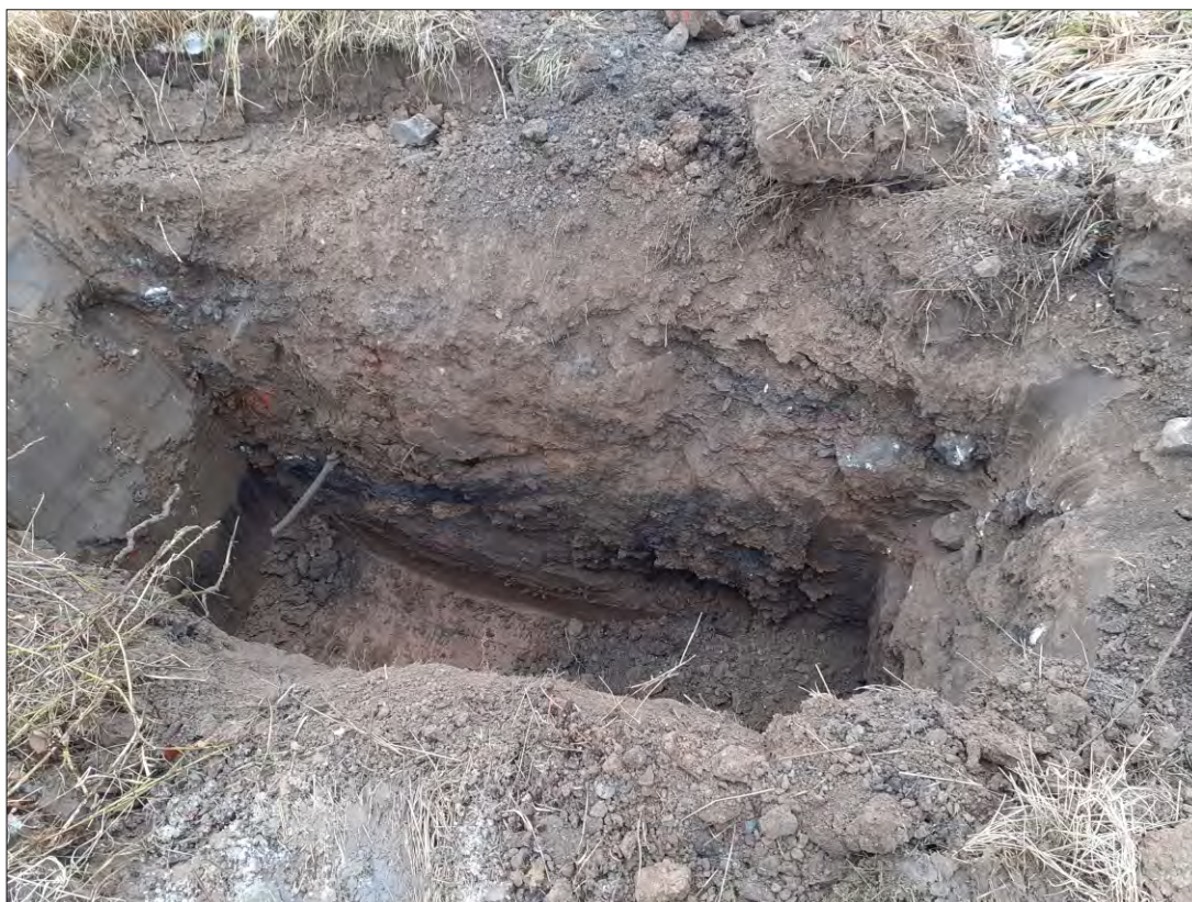
Foto č. 2: Kopaná sonda KS-1 - do 1,1 m p.t. navážka, od 1,1 m p.t. sprašové hlíny.
