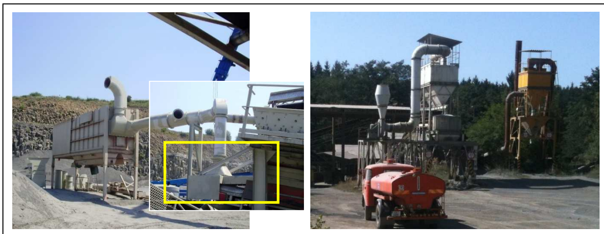
Obrázek č. 12: Příklady semimobilního (VLEVO) a stacionárního (VPRAVO) odsávacího zařízení našich kamenolomů
