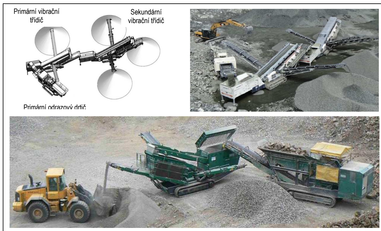
Obrázek č. 7: Příkladové schéma a sestavy mobilních zařízení
