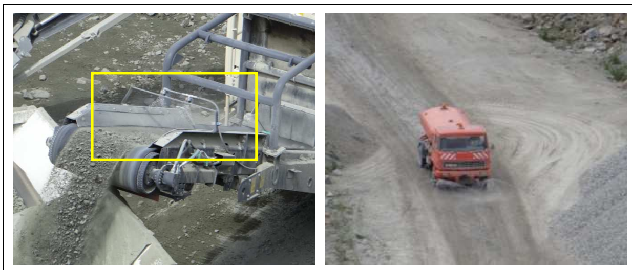
Obrázek č. 10: Detail mlžících trysek technologického zařízení, kropicí vůz na lomové komunikaci
