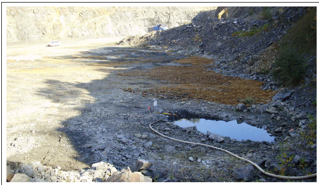
Obrázek č. 47: Ukázka způsobu odvodňování kamenolomů
