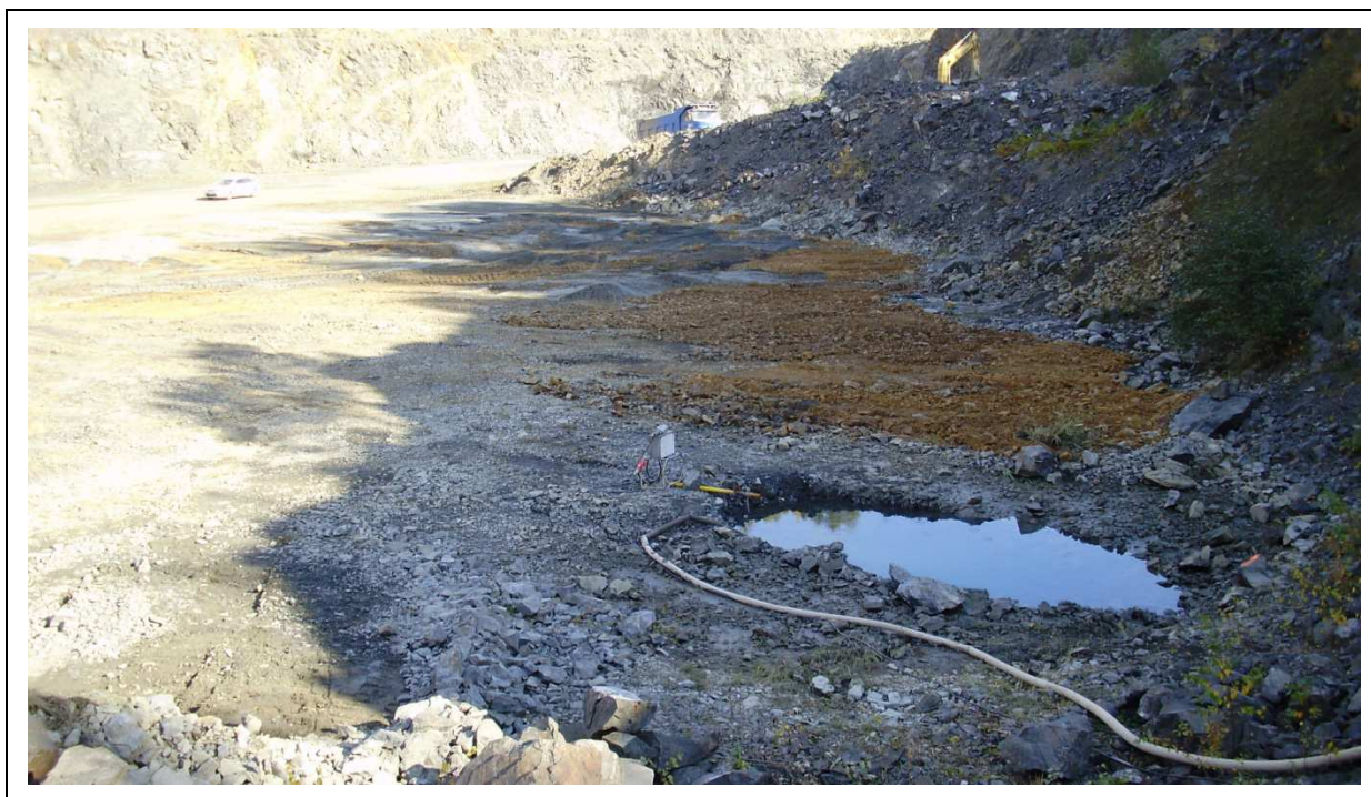
Obrázek č. 83: Ukázka způsobu odvodňování kamenolomů
