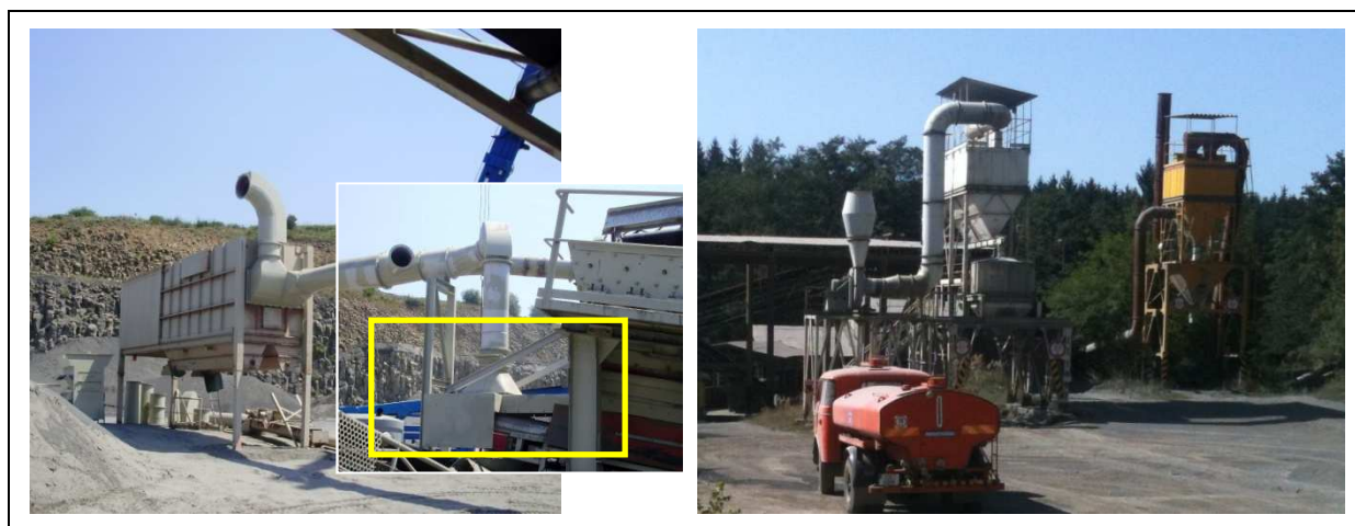
Obrázek č. 13: Příklady semimobilního (VLEVO) a stacionárního (VPRAVO) odsávacího zařízení našich kamenolomů
