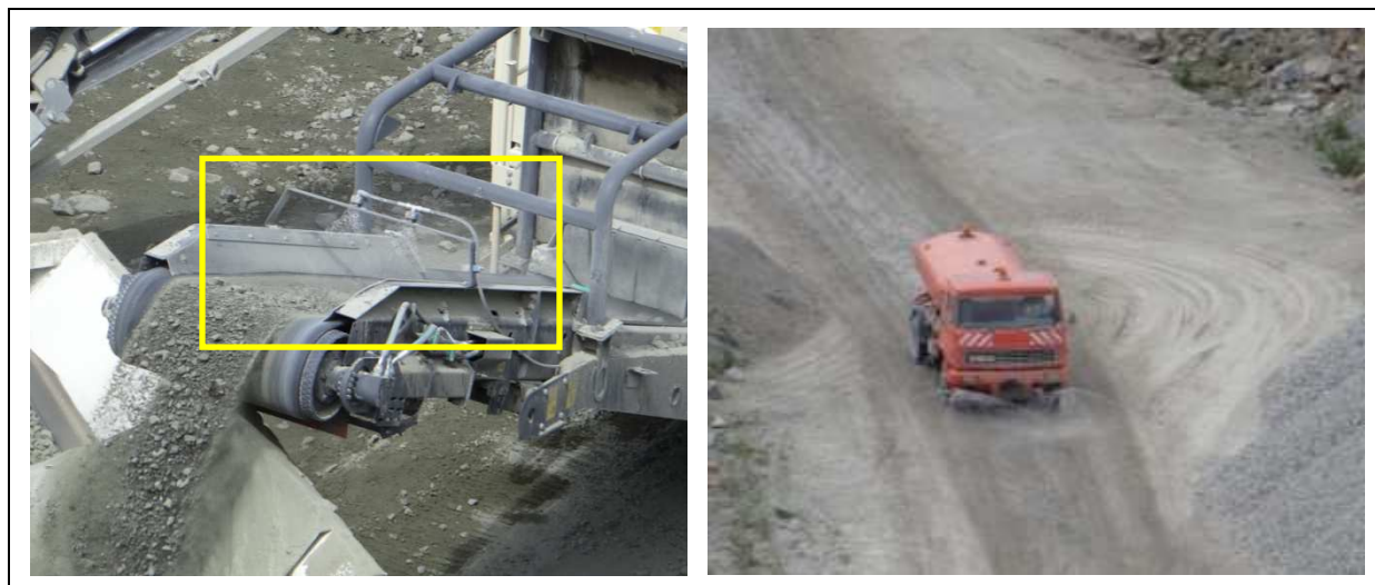
Obrázek č. 11: Detail mlžících trysek technologického zařízení, kropicí vůz na lomové komunikaci
