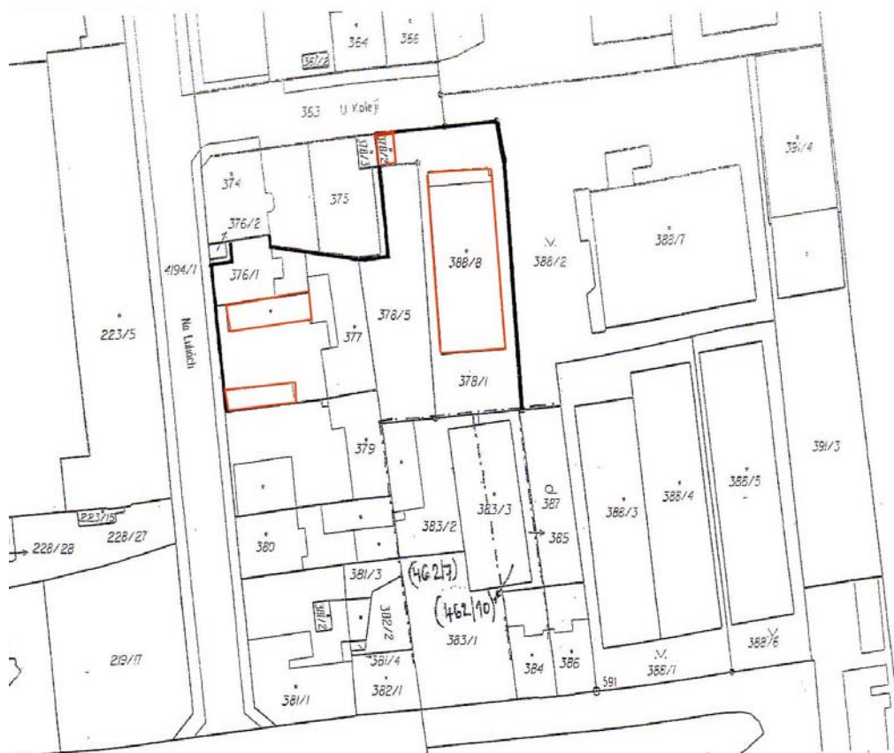
Obr. 3 Stávající situace areálu (červeně označeny objekty určené k demolici)
