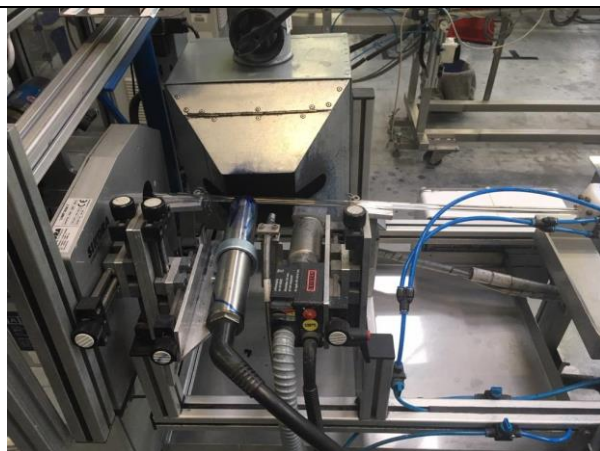
Obrázek č. 12: potisk hadic inkoustem
