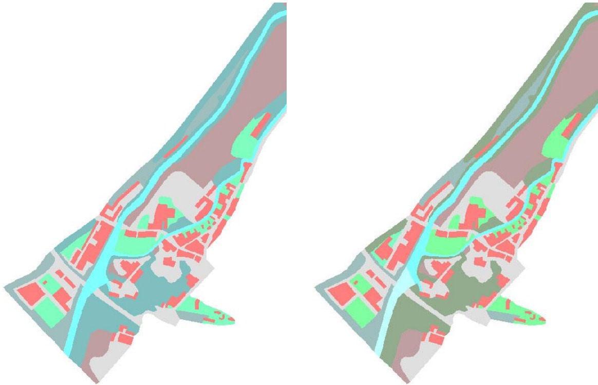
Obr. 5.2 – Porovnání použitých ploch definujících odpory proudění pro současný stav (levá část obrázku) a stav po realizaci návrhu nové haly (pravá část obrázku)
