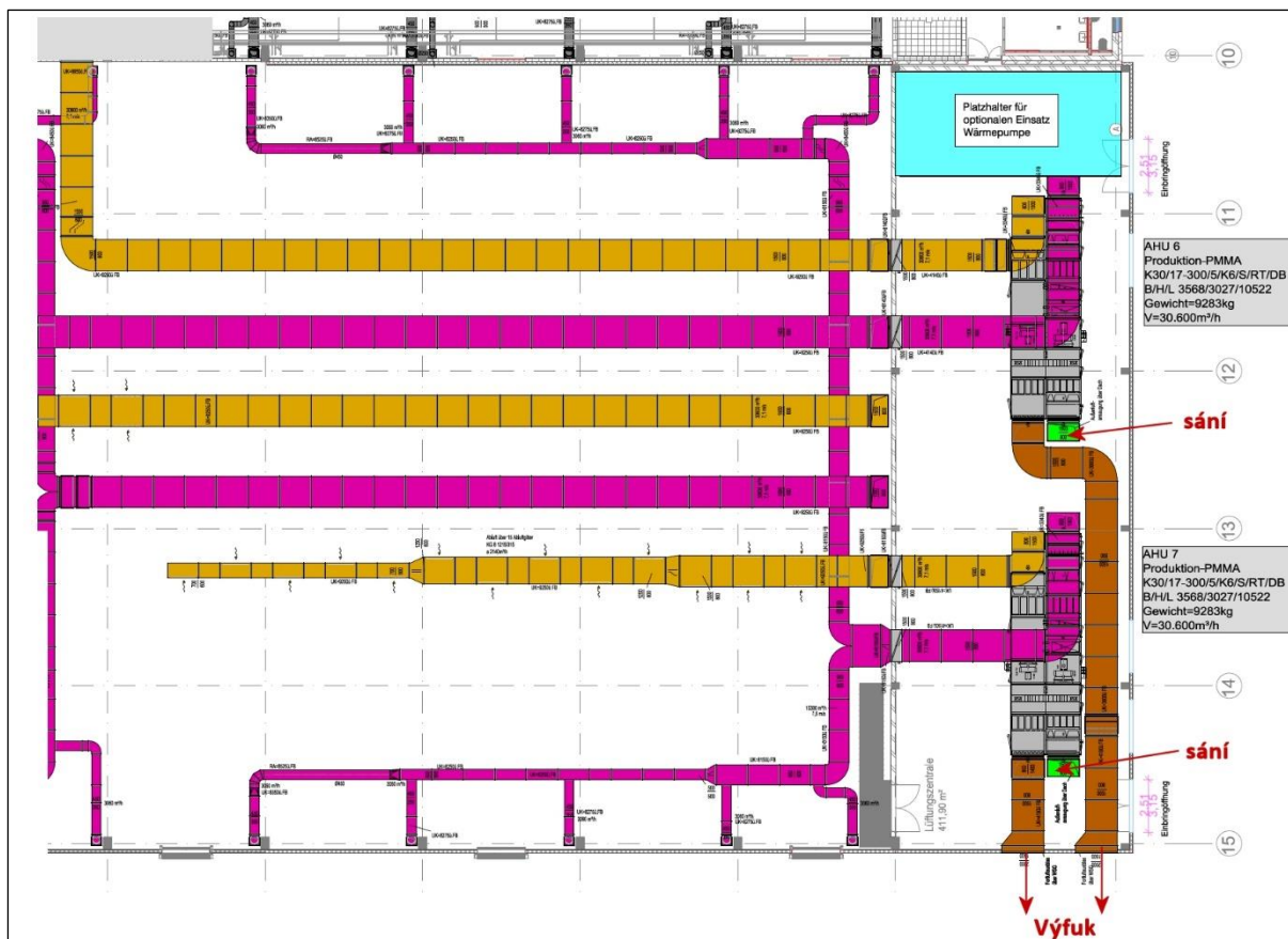
Obr. č. 9 Jednotky AHU 6 a AHU 7 v tech. místností, sání nad střechou, výfuk
