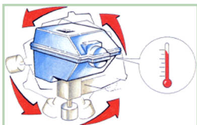
2. Ohřívání formy v peci za současného otáčení kolem dvou os
