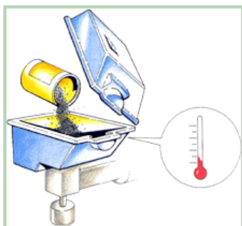
2. Ohřívání formy v peci za současného otáčení kolem dvou os
