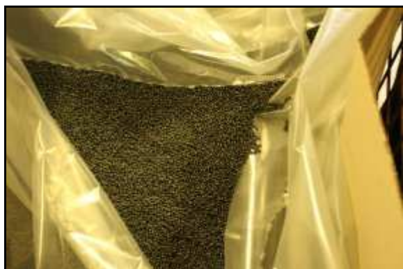
vstupní surovina – granulát termoplastu
