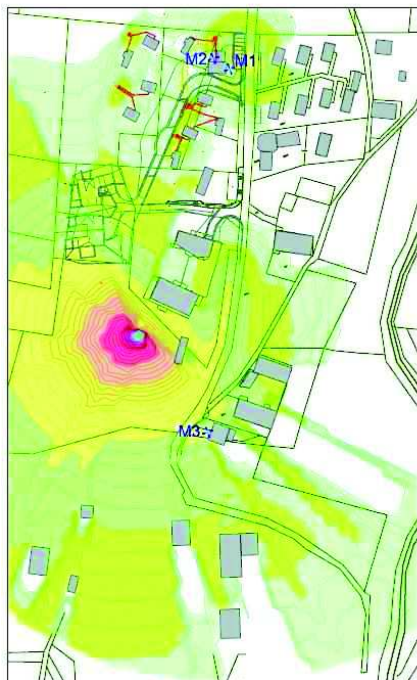
Obr. 4, Zákres izofonových polí – stacionární zdroje hluku včetně pohybů aut na parkovištích - denní doba
