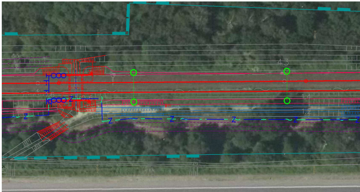
Obr.č.22 SO 32-81-81 Pardubice-Rosice nad Labem - Stéblová, přeložka stávajícího koryta vpravo železniční trati v žkm 6,1 - 7,0
