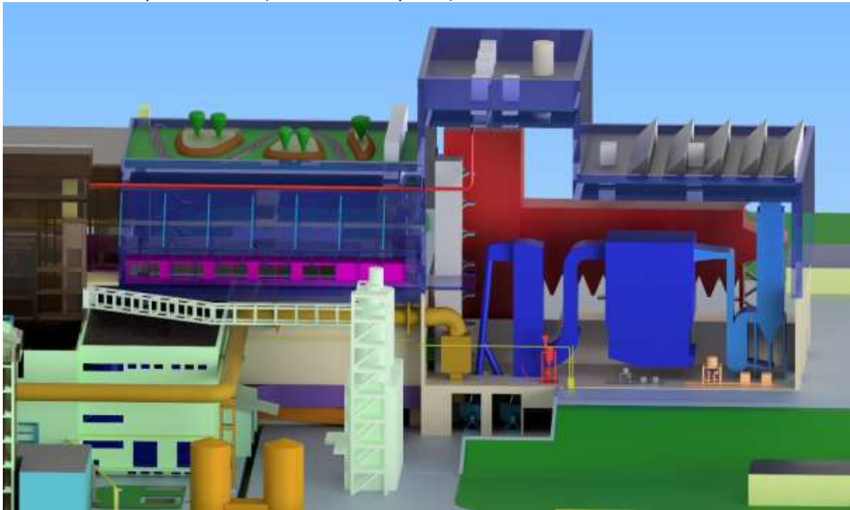
Obr. 10: Čištění spalin kotle K1 (bez stavebních příček)
