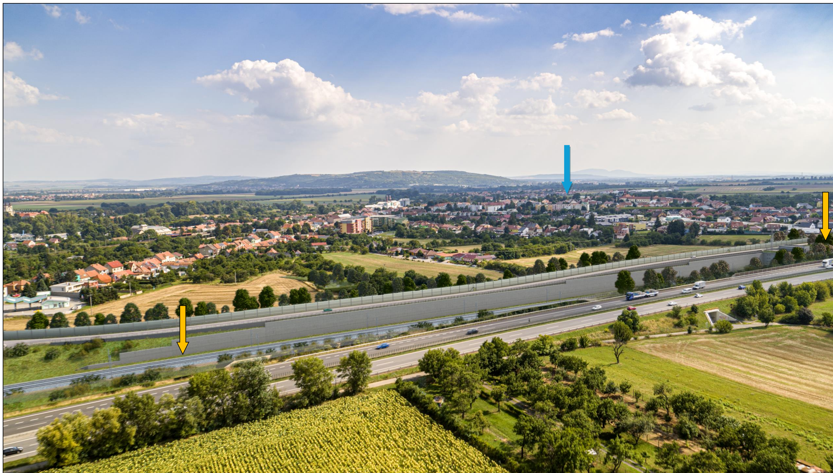
Obr. 78: Vizualizace záměru (zvýrazněna oranžovou šipkou, Valbek spol. s r. o., 2024) – Pohled ze vzduchu (z dronu) směrem od východu na vedení trasy VRT v hlubokém zářezu (oranžová šipka vlevo) v okolí Rajhradu (modrá šipka); kde dále trasa přes město (před ulicí Stará pošta) vede tunelem (oranžová šipka vpravo); zřejmá nepůvodní městská zahuštěná zástavba Rajhradu, včetně sídlišť i satelitů
