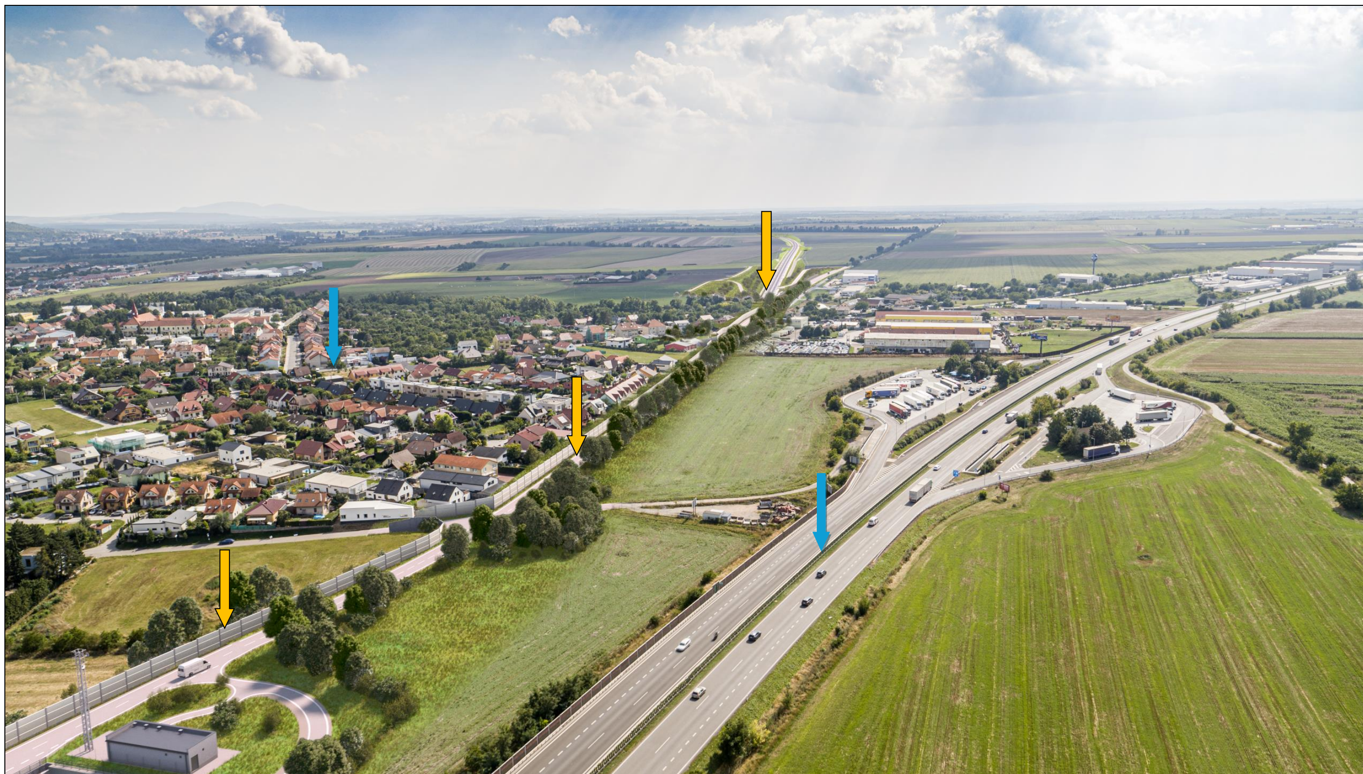
Obr. 79: Vizualizace záměru (zvýrazněna oranžovou šipkou, Valbek spol. s r. o., 2024) – Pohled ze vzduchu (z dronu) směrem od severu na vedení trasy VRT v okolí Rajhradu v souběhu se stávající D52 (modrá šipka) – trasa vede v tunelu pod stávající komunikací, která bude přeložena; stávající komunikace bude doplněna o PHS směrem k Rajhradu a ozeleněna
