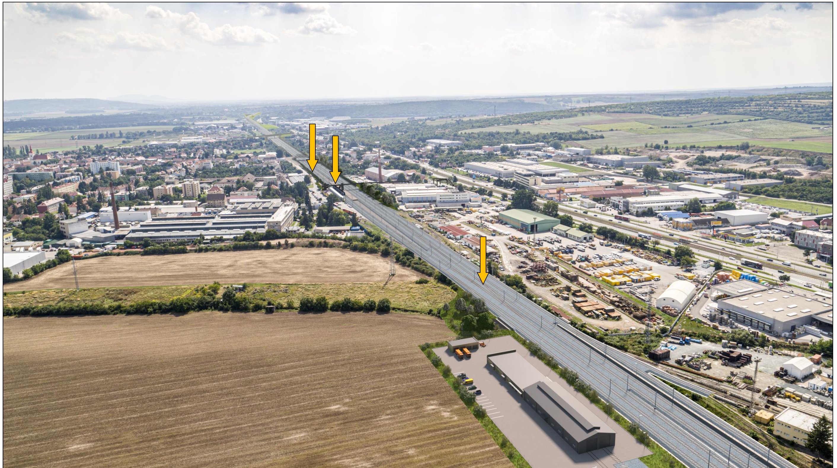
Obr. 76: Vizualizace záměru (zvýrazněna oranžovou šipkou, Valbek spol. s r. o., 2024) – Pohled ze vzduchu (z dronu) směrem od jihu na vedení trasy VRT v Modřicích, a to silně zastavěným a antropicky ovlivněným územím (zřejmě velké průmyslové, logistické a skladovací objekty, komíny, sídlištní zástavba atd. s negativním projevem), umístění PHS (oranžová šipka v pozadí); modernizovaná stanice Modřice a pěší lávka spojující stanici Modřice s ulicí Brněnskou (prostřední oranžová šipka)
