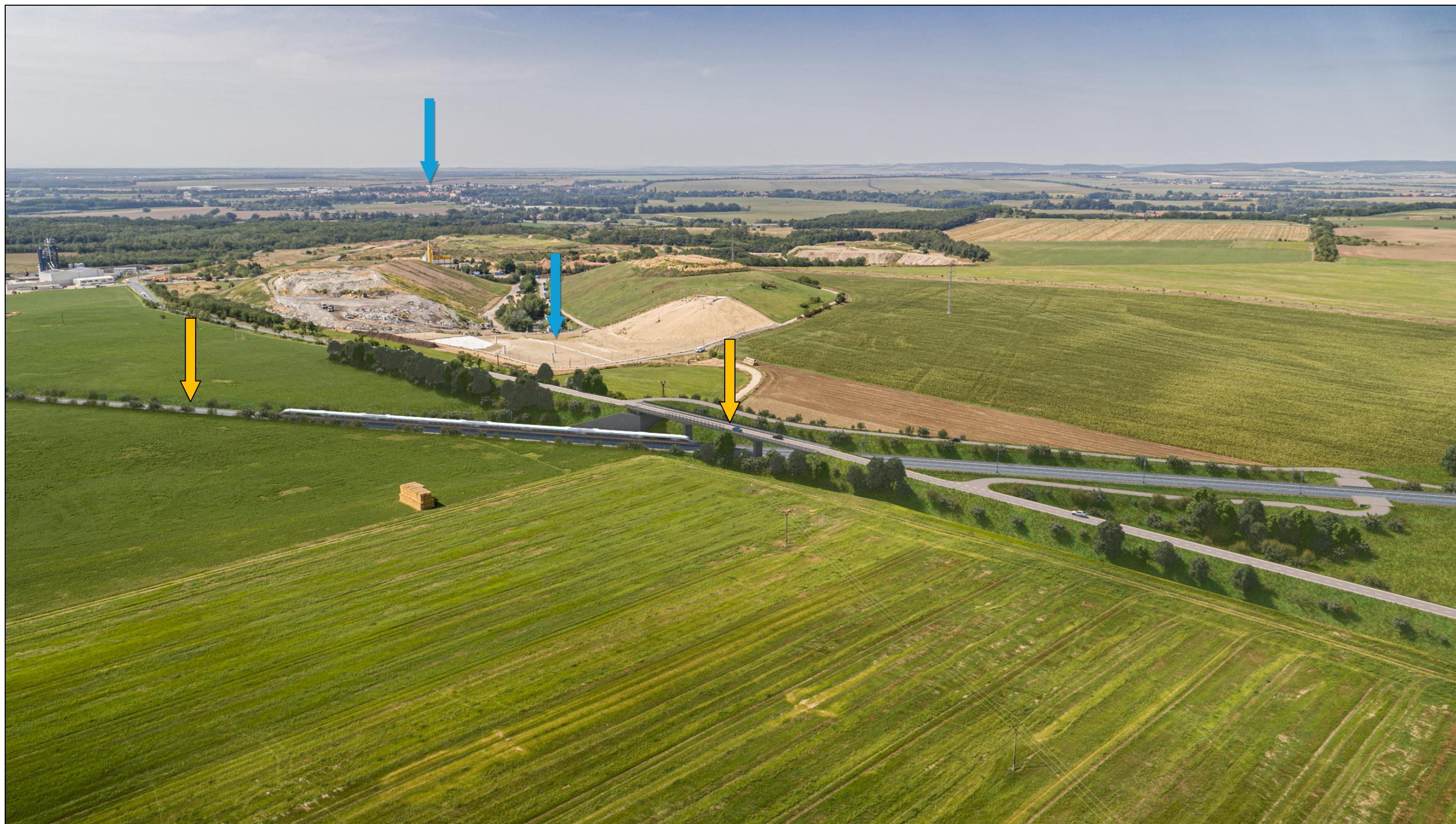
Obr. 84: Vizualizace záměru (zvýrazněna oranžovou šipkou, Valbek spol. s r. o., 2024) – Pohled ze vzduchu (z dronu) od severovýchodu na trasu VRT vedenou přes velké bloky zemědělské půdy a přes okraj pískovny v Žabčicích (modrá šipka vpravo), na snímku je zřejmé vedení nového silničního nadjezdu pro silnici mezi Žabčicemi a Pohořelicemi; v pozadí zástavba Pohořelic (modrá šipka vlevo); znatelný urbanistický tlak na krajinu díky těžbě štěrku s negativním projevem, stejně tak jako technicistní prvky v podobě stožárů elektrického vedení
