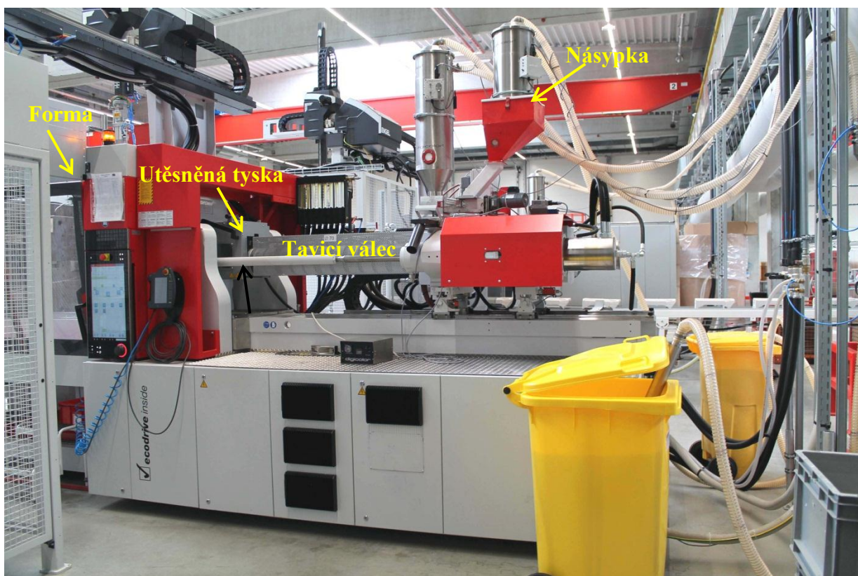
Obrázek č. 3 – Ilustrační obrázek s pohledem na moderní vstřikovací stroj
