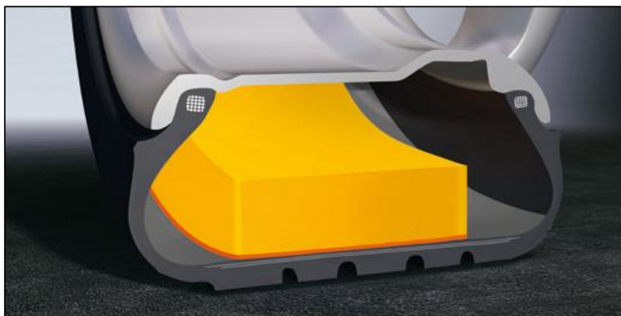
Obrázek 3: Schématické znázornění pneumatiky s technologií Contiilent™
