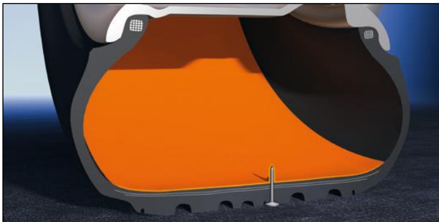
Obrázek 4: Schématické znázornění pneumatiky s technologií ContiSeal™
