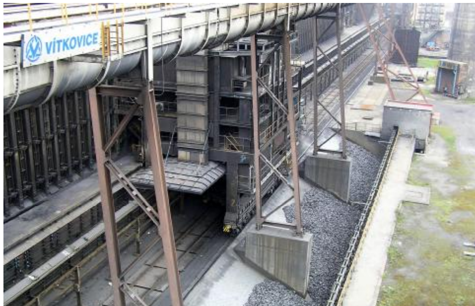
Obrázek B4: Koksová strana VKB 11 s vodícím (převáděcím) vozem a koksovou rampou
