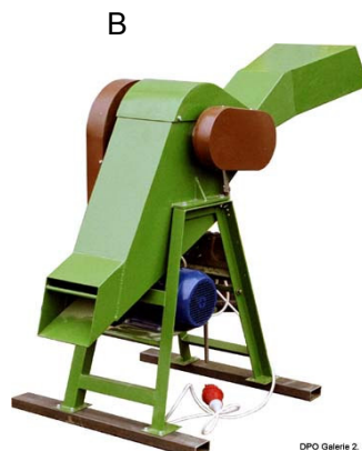
Obrázek č. 3: Příklad štěpkovače s pohonem hřídelí (A) a s pohonem elektromotorem (B)
