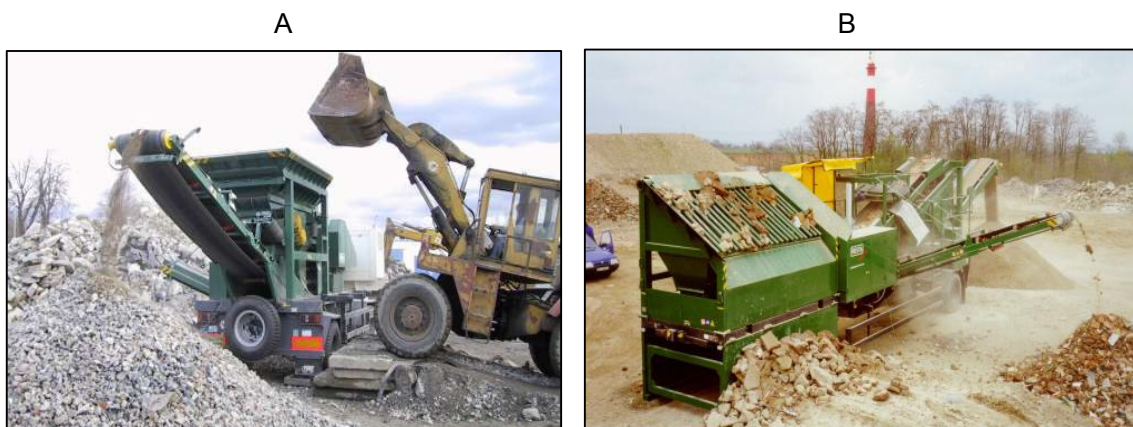
Obrázek č. 9: Příklad mobilní drtičí (A) a třídící (B) linky zpracovávající stavební odpady
