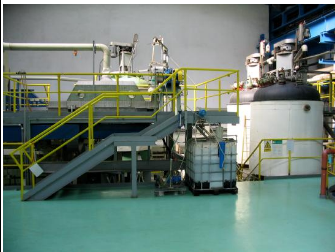
Stávající výrobní linka chloridu hořečnatého - koncová část
