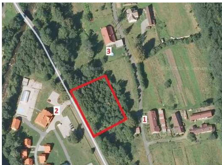
Obr. 1 Poloha výpočtových bodů pro stanovení hladiny akustického tlaku A z provozu parkoviště
