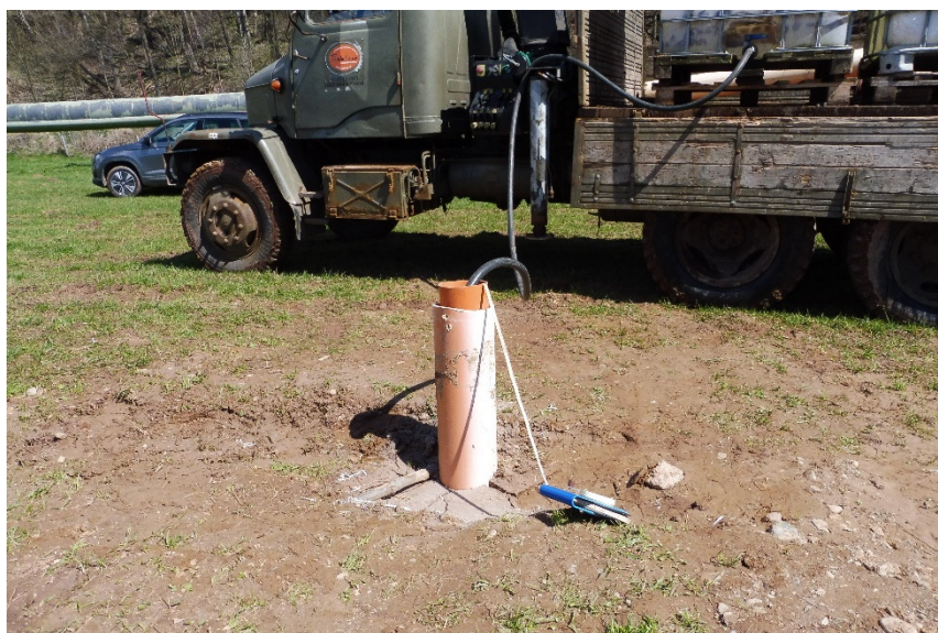
Foto č. 6: Nálev vody při vsakovací zkoušce v sondě HGS-2
