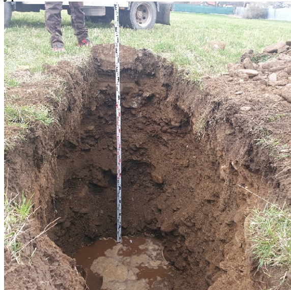
Foto č. 2: Zaměření ustálené hladiny vody v sondě po dosažení konečné hloubky
