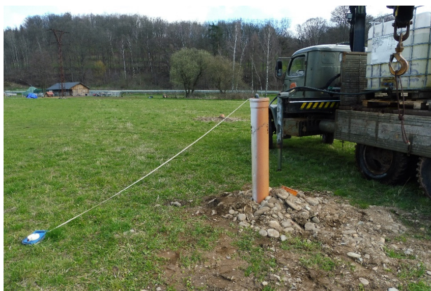
Foto č. 9: Vsakovací zkouška v sondě HGS-4
