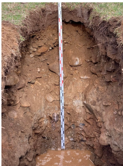
Foto č. 7: Zaměření hladiny vody v průzkumné sondě HGS-3 po jejím vyhloubení
