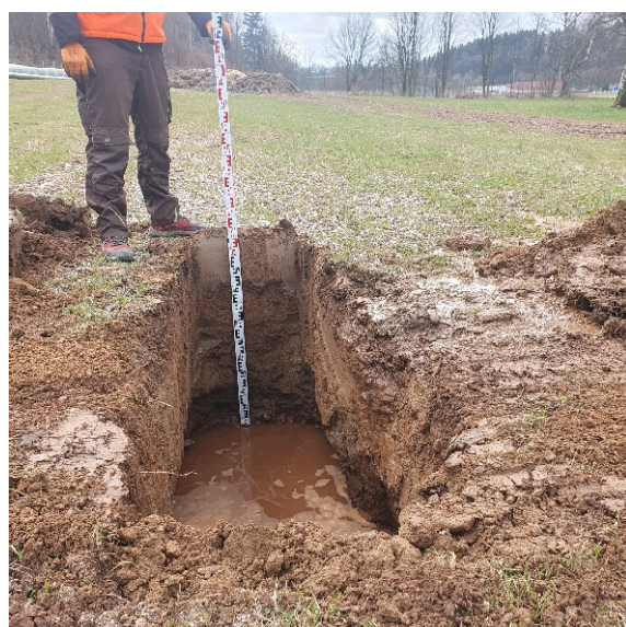
Foto č. 5: Zaměření ustálené hladiny vody v sondě
