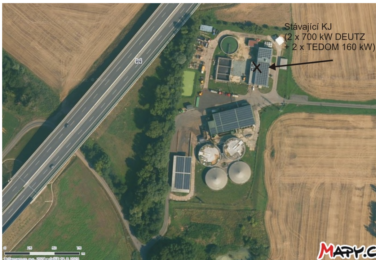
Obr. č. 3 Areál BPS Jaroměř – letecký snímek, umístění stávajících KGJ (zdroj: mapy.cz)
