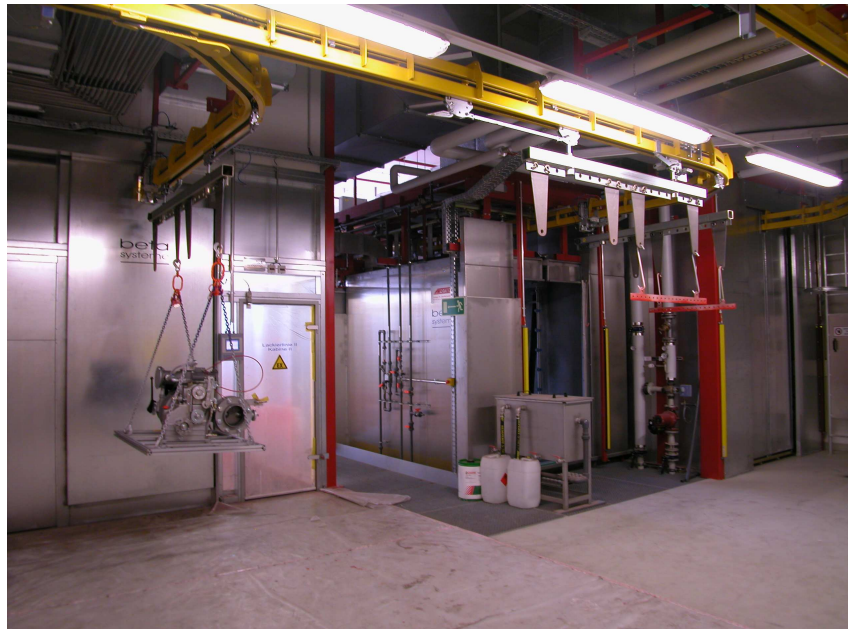
Obr. 3 – Lakovací kabina linky AFOTEK (2)
