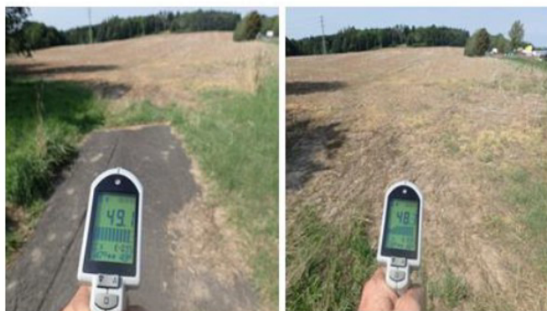
Obr. 6. Benešovsko 26. 8. 2017, intenzita dopadajícího slunečního záření 650 W.m-2. Srovnání povrchové teploty asfaltu (49,1 °C) a navazujícího sklizeného pole (48,3 °C). Měřeno okolo 15:00 SEČ
