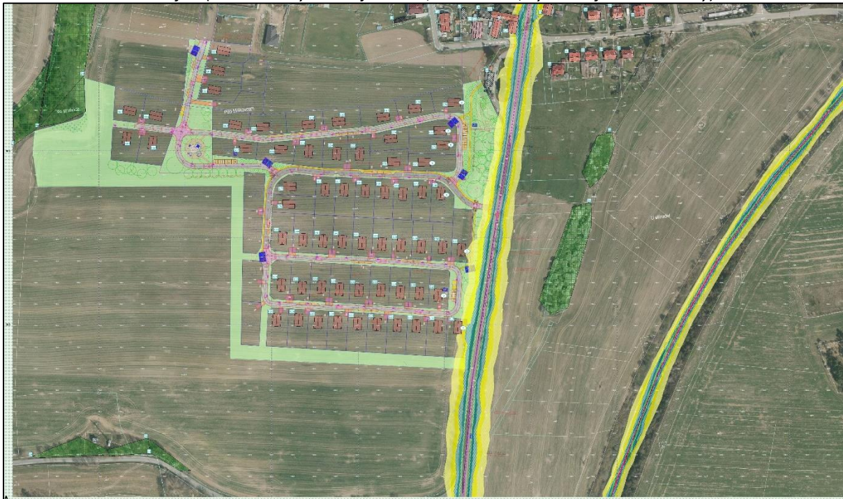
Obrázek 28: Průběh izofon (hluk z liniových zdrojů - 2028, noční doba, výška izofon h = 2 metry)
