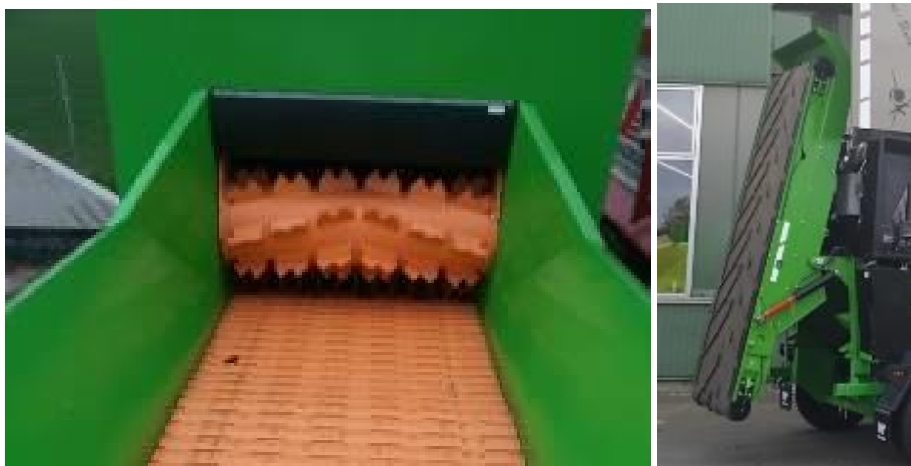
Obr. č. 4, 5 – Drtič Willibald MINISHARK MS 3000 – vkladací stůl a vynášecí dopravník
