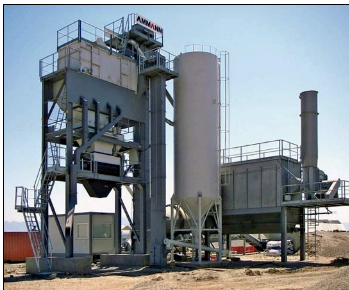
Obr. č. 2 - Ukázka obalovny JustBlack o kapacitě 80-240 t/hod. (zdroj: http://www.ammann-group.cz/ )
