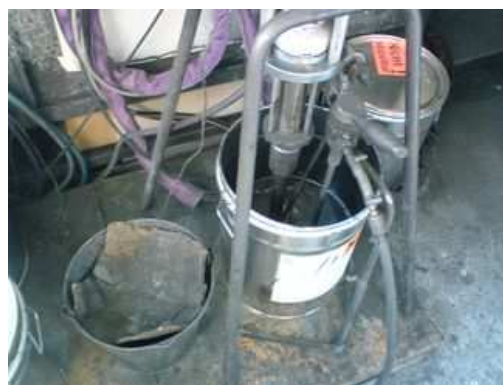
Obrázek č. 15: Příprava barvy v mokré lakovně
