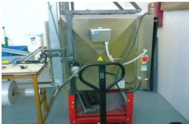
Obrázek č. 7: Malá pec na smaltování + manipulační vozík
