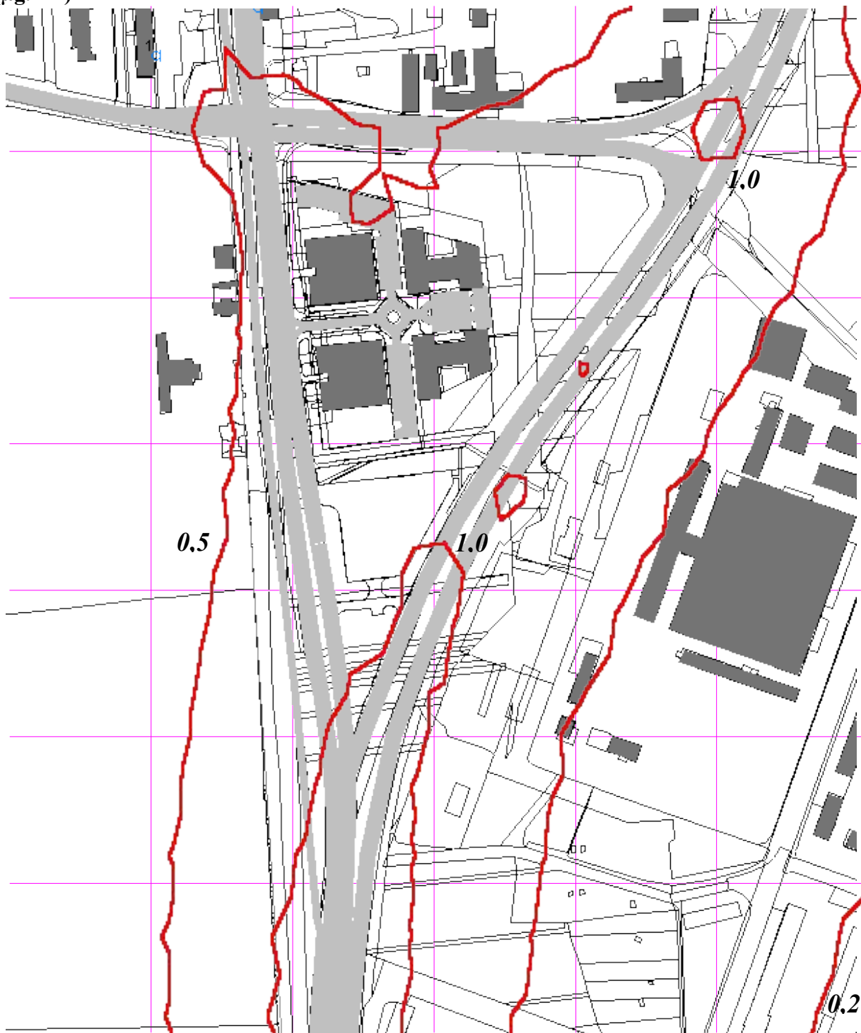
Obr. č. 25 - C. Grafická část - Imisní koncentrace aritmetických ročních průměrů tuhých látek ( \mu\text{g}\cdot\text{m}^{-3} )
