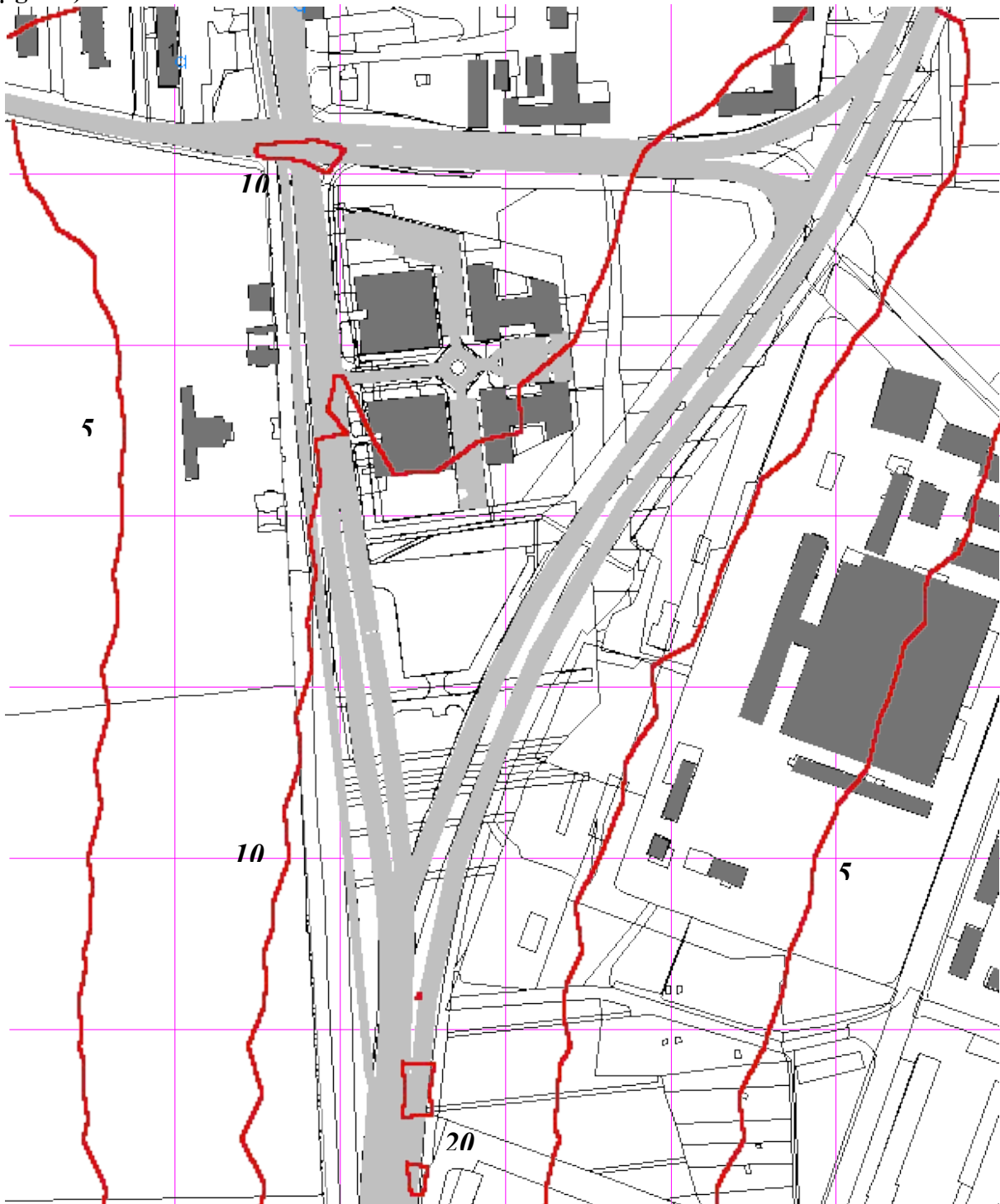
Obr. č. 26 – C. Grafická část - Imisní koncentrace aritmetických ročních průměrů \text{NO}_x ( \mu\text{g}\cdot\text{m}^{-3} )
