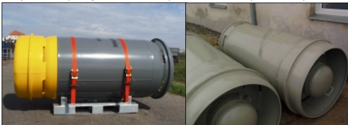
Obr. 4 – Sud CM 500, celkový pohled a detail víka
