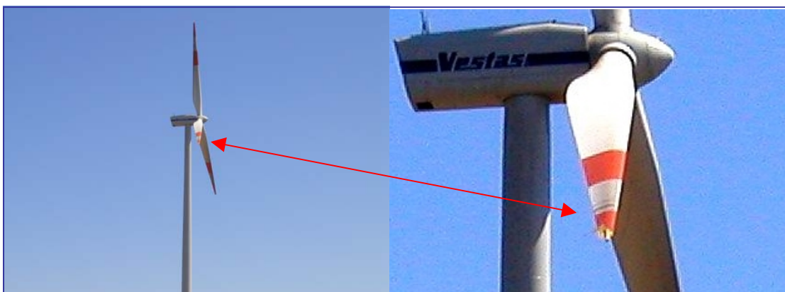
Příklad poškození při přímém zásahu bleskem
