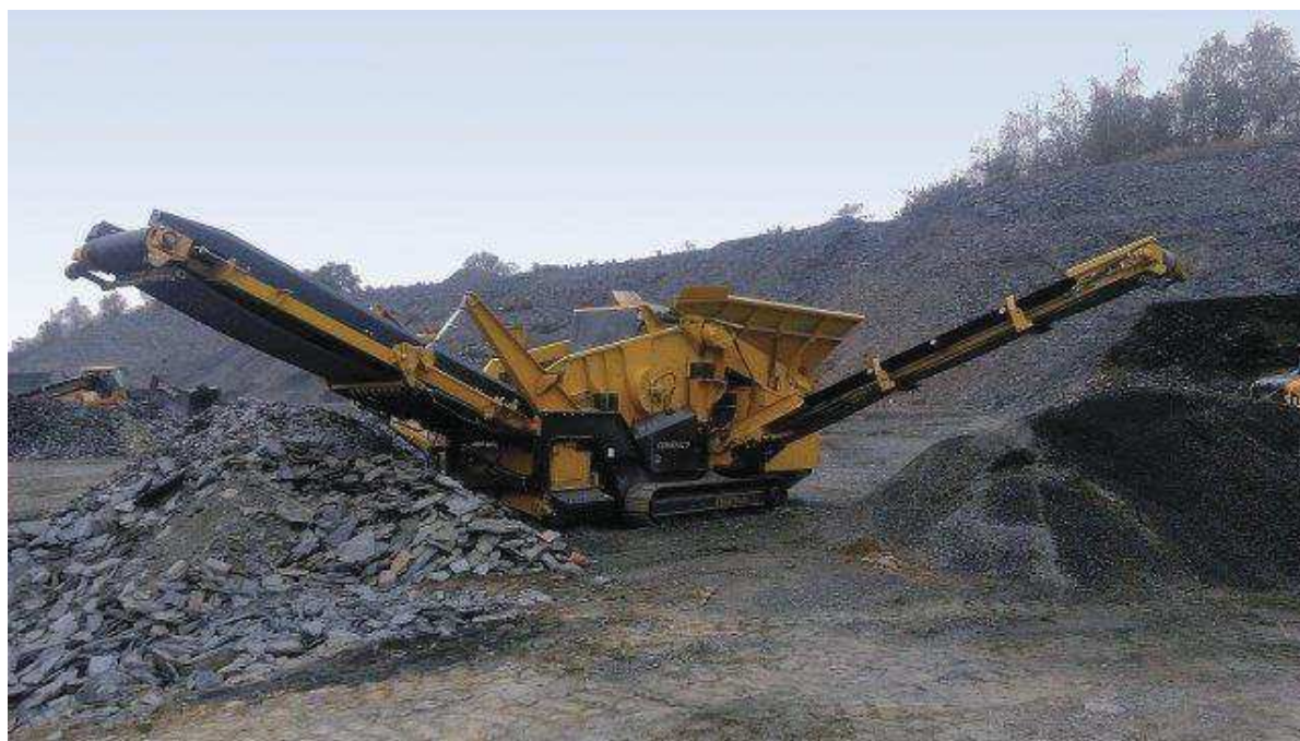
Obr. č. 4 Třídící linka KEESTRACK COMBO 90GO
