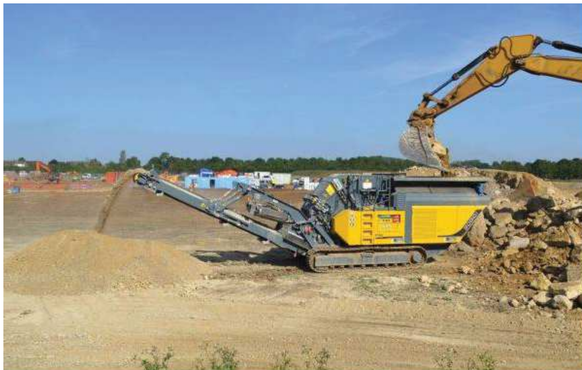
Obr. č. 3 Zařízení na drcení odpadu RUBBLE MASTER Compact crusher RM 90GO
