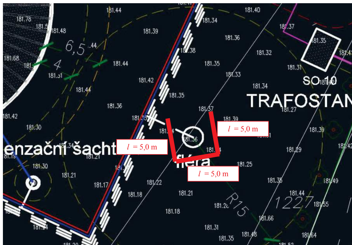
Obr. 2 Umístění protihlukové clony u hořáku zbytkového plynu – ve vzdálenosti 2,5 m od středu hořáku
