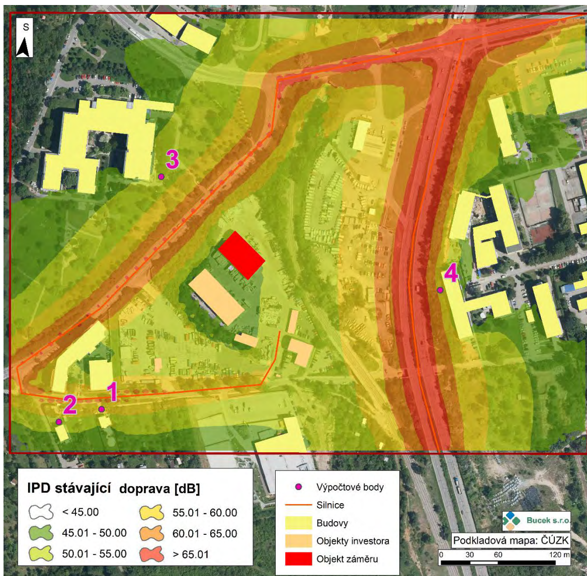
Obr. 43: Hluková zátěž způsobená stávající dopravou uskutečňovanou v okolí předmětného záměru během denní doby (od 6:00 do 22:00), výška 4 m
