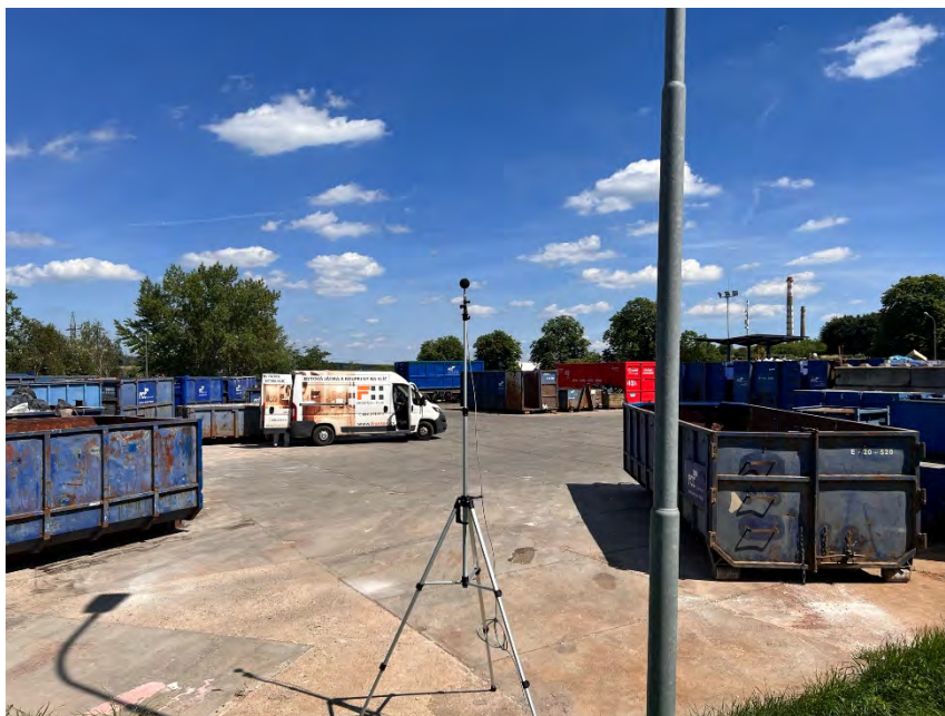
Obr. 23: Měření stacionárních zdrojů – areál sběrného dvora
