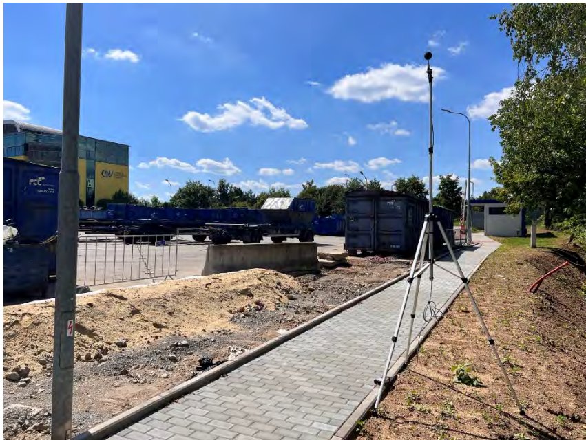
Obr. 26: Měření stacionárních zdrojů – areál sběrného dvora
