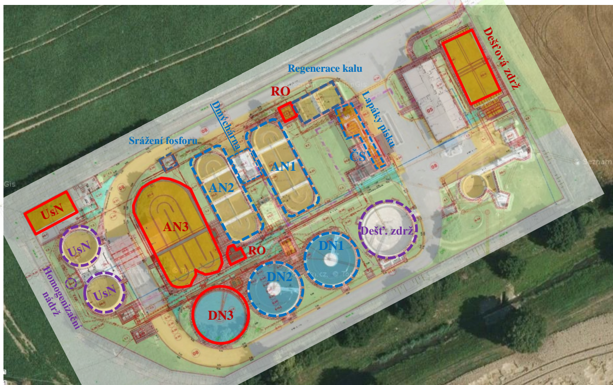
Obr.7 – nově budovaná ○ , upravovaná ○ a rušená ○ zařízení ČOV
